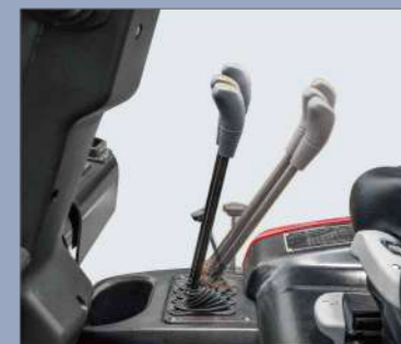
Die Abdeckung kann leicht geöffnet werden, indem die Pegel nach vorne eingestellt werden
